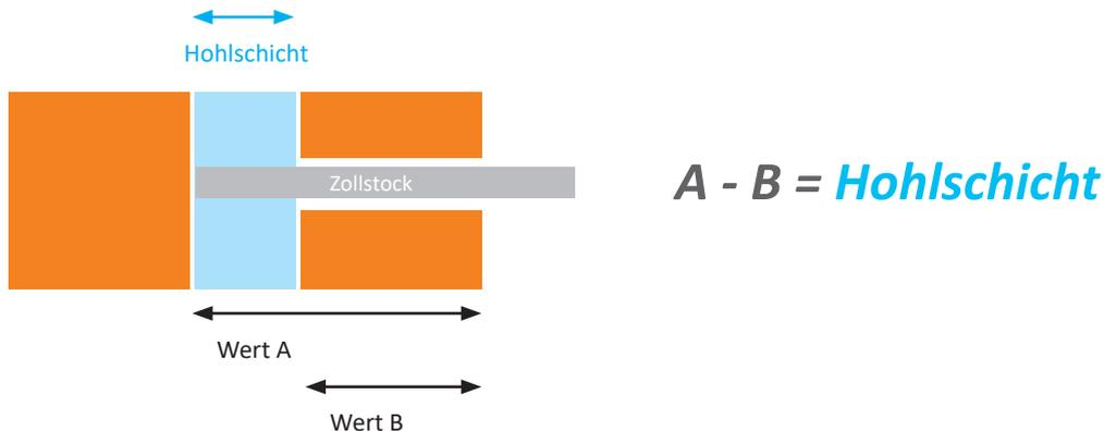
Üblicherweise ist sie in vorliegenden Zeichnungen zu sehen. Wenn dies nicht der Fall ist, können sie Vorhandensein und Größe der Luftschicht aber auch selbst ermitteln. Dazu bohren sie im Bereich der zu dämmenden Außenwand mit einer Bohrmaschine und einem **etwa 2 cm großen Bohrer** vorsichtig ein Loch. Gehen Sie dabei langsam vor, damit sie bemerken, wenn der Widerstand nachlässt und sie auf eine Luftschicht stoßen. Dann hören Sie auf zu bohren.
